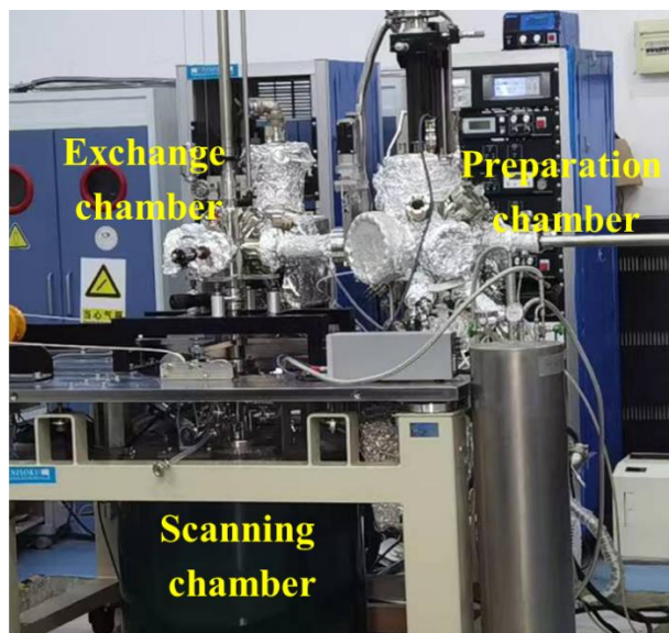
图 2-2 极低温强磁场扫描隧道显微镜
